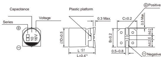
( $\varnothing 8\times 10.5\sim\varnothing 16$ ) Unit: mm
